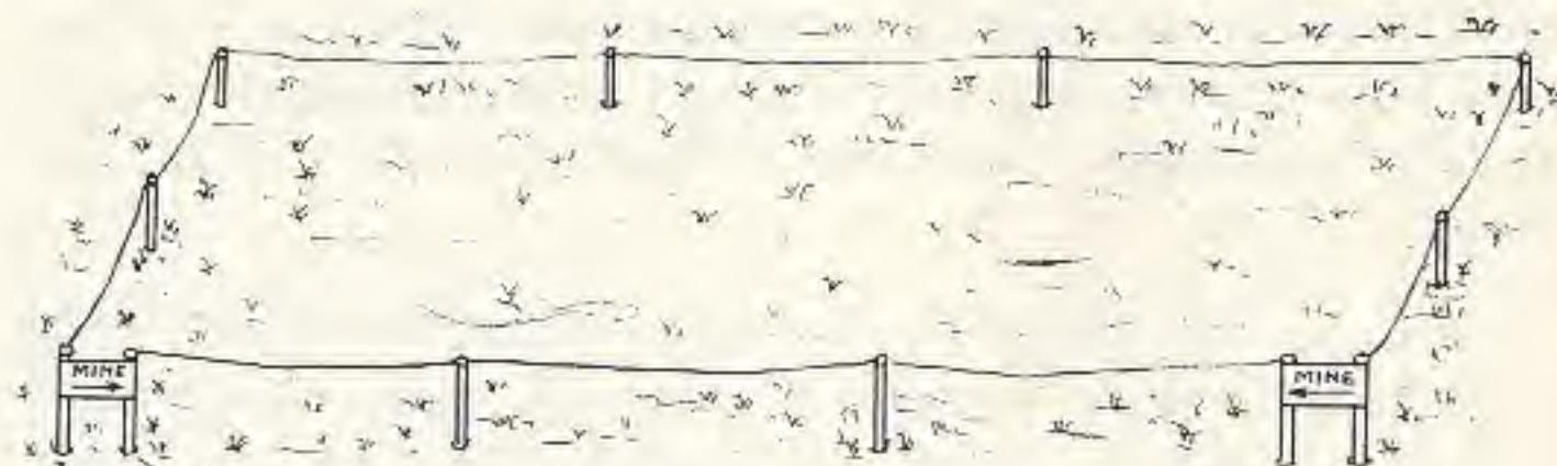
Broj znački određuje se prema potrebi, a ograđivanje se može vršiti i bez njih. U nedostatku formacijskih znački se mogu izraditi od priručnih sredstava
